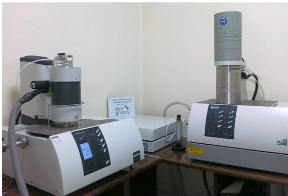
Aparatura do pomiarów przewodnictwa cieplnego metodą laser-flash LFA 457 MicroFlash™ oraz aparatura do pomiaru ciepła właściwego DSC 404 F3 PEGASUS firmy NETZSH.
