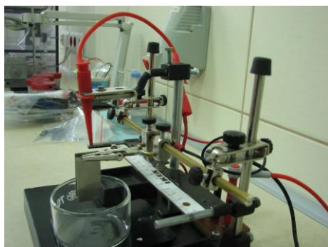
Rys.1. Przykładowe układy do elektroforezy nanocząstek ceramicznych i węglowych, nanoszonych na powierzchnie metali
